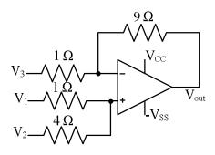
$(A) 1.8V_1 + 7.2V_2 - V_3 \quad (B) \ 2V_1 + 8V_2 - 9V_3 \quad (C) \ 7.2V_1 + 1.8V_2 - V_3 \quad (D) \ 8V_1 + 2V_2 - 9V_3$
