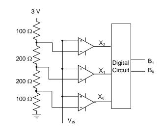
(A)  $X_0[\overline{X_2 \oplus X_1}]$  (B)  $\overline{X}_0[\overline{X_2 \oplus X_1}]$  (C)  $X_0[X_2 \oplus X_1]$  (D)  $\overline{X}_0[X_2 \oplus X_1]$
